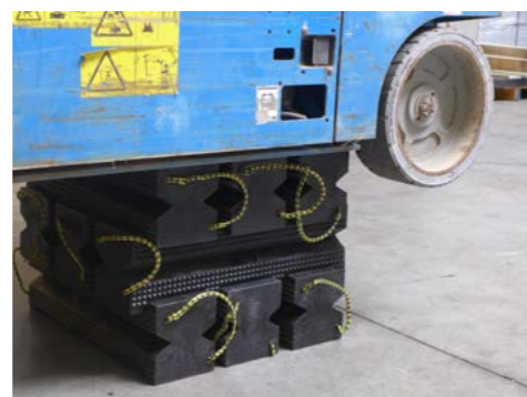
▲ Bloki stabilizacyjne zaprojektowano zgodnie z systemem bloków ryglujących. Na tym zdjęciu widzimy bloki SB 002B skonfigurowane do zastosowania jako 3-stopniowa kaszyca.
