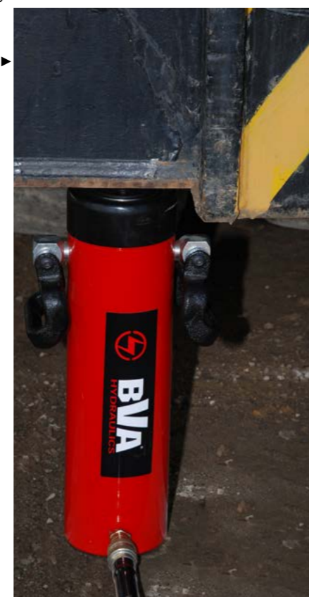
Cylinder jednostronnego działania H5513 w pozycji opuszczonej, gotowy do podnoszenia ładunku.
