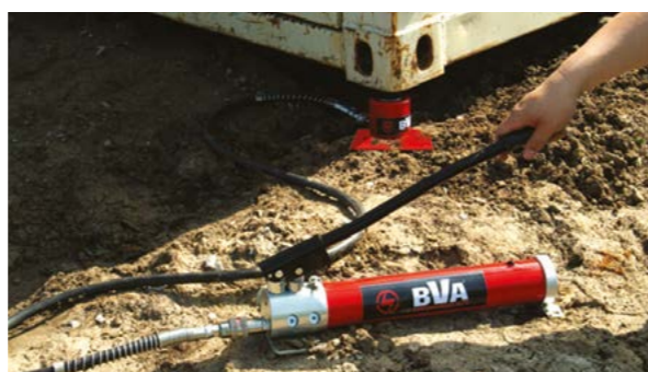
Cylindry niskoprofilowe świetnie nadają się do ciasnych przestrzeni.
