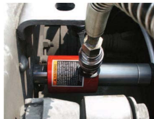
▲ Zdejmowanie koła z piasty za pomocą prasy miniaturowej. Mieści się pomiędzy podwoziem a kołem.
